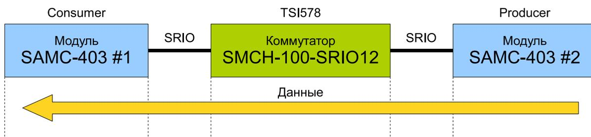
Рисунок 1-1: Схема соединения модулей SAMC-403 через коммутатор SMCH-100-SRIO12
