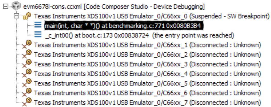
Рисунок 5-12: Окно «Debug» после загрузки программы
